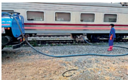
รูปที่ 3-5 เจ้าหน้าที่ของบริษัทเอกชนมาสูบล้างสิ่งปฏิกูลจากถังรองรับสิ่งปฏิกูลใต้ตู้โดยสารของขบวนรถไฟ
