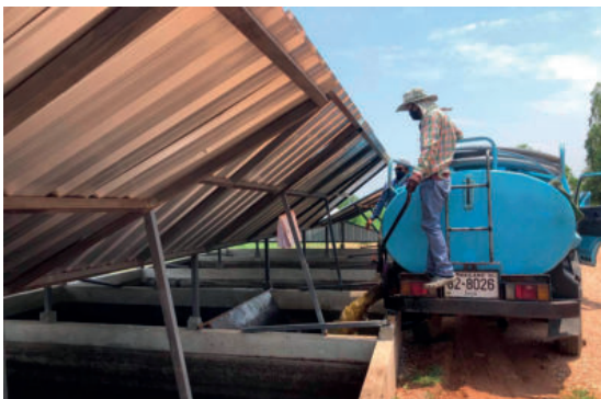
รูปที่ 4-7 การปล่อยโดยการไหลด้านท้ายรถ (Gravity Flow)
