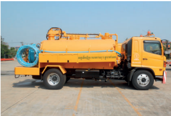
รูปที่ 4-5 รถสูบล้างสิ่งปฏิกูลขนาด 5 ลูกบาศก์เมตร
