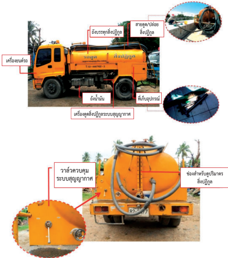
รูปที่ 4-3 รถสูบล้างสิ่งปฏิกูลในประเทศไทย
