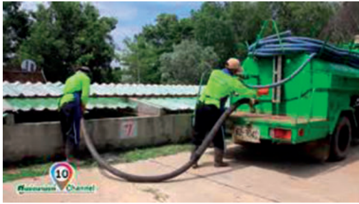
รูปที่ 4-8 การปล่อยทิ้งโดยใช้แรงดันภายในถัง
