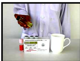
ภาพที่ 19 ขั้นตอนที่ 3 การทดสอบคลอรีนอิสระคงเหลือในน้ำ
