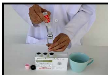
ภาพที่ 18 ขั้นตอนที่ 2 การทดสอบคลอรีนอิสระคงเหลือในน้ำ
