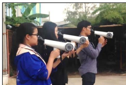
รูปที่ ๑ เครื่องมือตรวจวัดกลิ่นในบรรยากาศภาคสนาม (Nasal Ranger) และหลักการทํางาน
