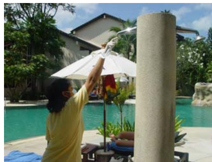
รูปที่ 16 แสดงการเก็บตัวอย่างน้ำเพื่อวิเคราะห์หาเชื้อลีเจียนเนลลา
