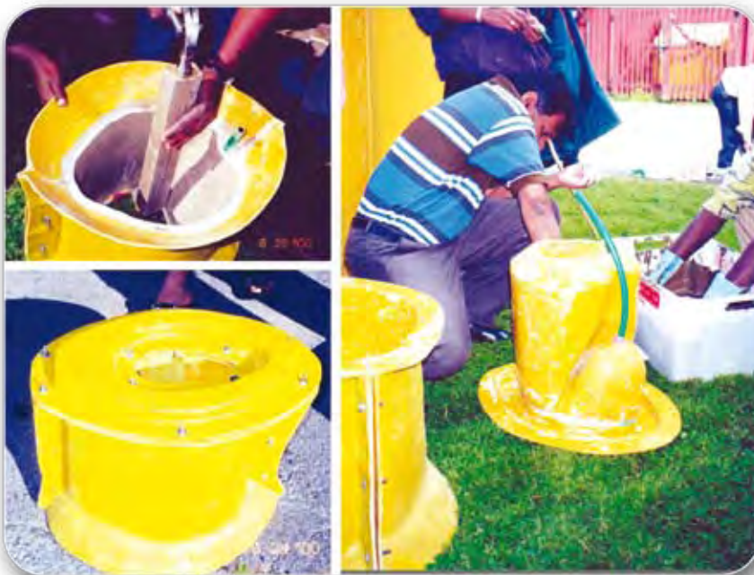
รูปที่ 3 - 11 การประกอบโถส้วมแยกปัสสาวะแบบไม่ใช้น้ำที่ผลิตจากไฟเบอร์กลาส
