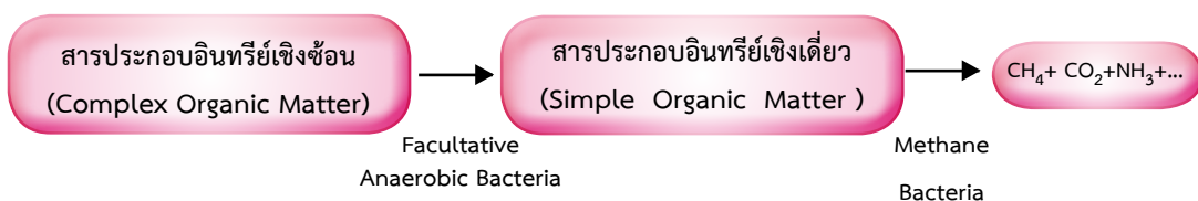
รูปที่ 3 - 3 แสดงขั้นตอนการย่อยสลายของสารอินทรีย์ในสภาวะที่ไม่มีออกซิเจน
