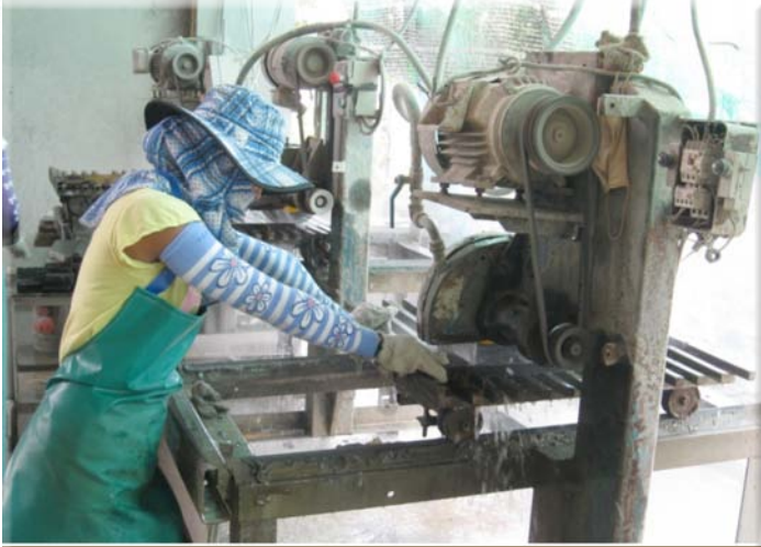
การนำหินเข้าเครื่องตัดเพื่อให้ได้ขนาดตามที่ต้องการ
