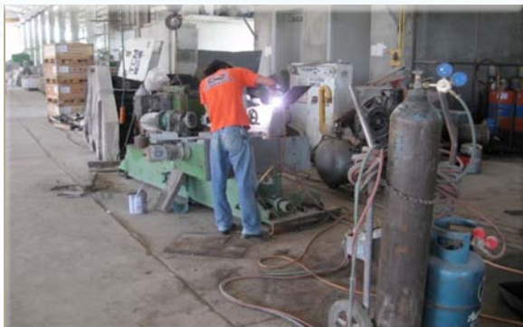
สภาพการทำงานที่ต้องใช้แก๊ส ไฟฟ้า ซึ่งอยู่ใกล้กับจุดเก็บน้ำมัน/สารเคมี
