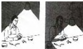
รูปที่ 2 การติดตั้งโคมไฟให้มีระดับที่สูงพอเหมาะ
